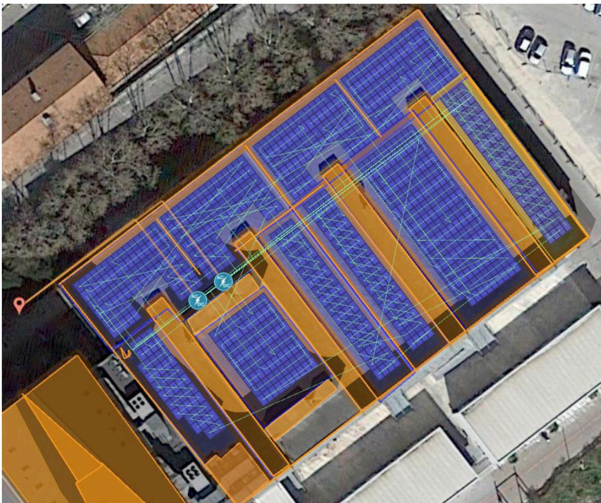
Le toit de la Cartonnerie sera prochainement équipé d'une centrale photovoltaïque d'une puissance installée d'environ 300 kW et de 800 panneaux. La production annuelle est estimée à 370 MWh, soit l'équivalent de la consommation annuelle de 80 foyers (hors chauffage). La production est susceptible de couvrir environ 85 % des besoins électriques du site.
